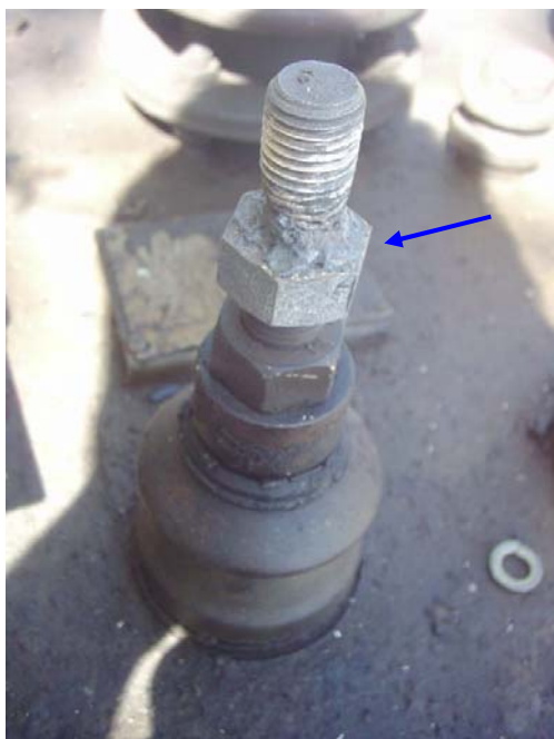
شکل ۲-۱۶- ترانسفورماتوری که پوشینگ فشارضعیف نشت روغن شده است [۱۴] .
